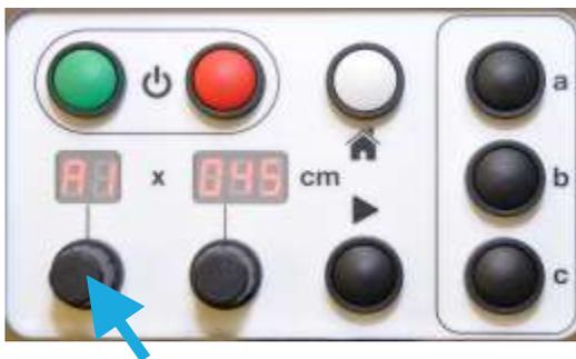
1. Ruotare la manopola di selezione quantità in senso antiorario per impostare il valore "A1".
