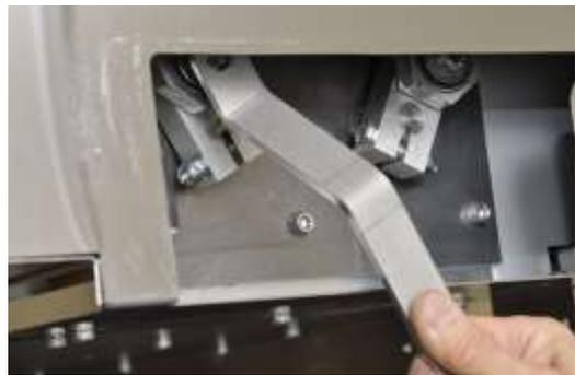
4. Individuare lo strumento di ripristino della lama (fornito) sulla manovella. Ruotare la manovella in senso orario nella posizione mostrata.
