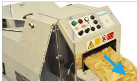
4. Rimuovere il materiale dal canale di uscita; la macchina genererà un altro imballaggio. Se non si inserisce un imballaggio, "A1" lampeggia per indicare che l'operazione semiautomatica è attiva; premere il pulsante "Home" per annullare questa operazione.
