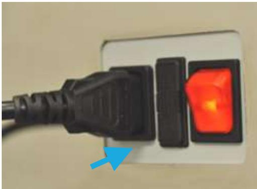
1. Controllare che la macchina sia collegata alla presa di alimentazione e accesa e che l'indicatore al neon sia illuminato.
