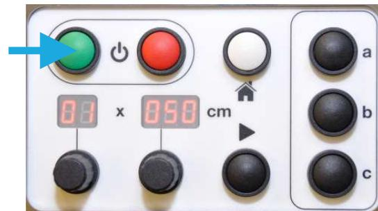
4. Avviare la macchina premendo il pulsante verde contrassegnato dalla "I". Il display si illuminerà. Se il display visualizza dei "trattini" lampeggianti, sarà necessario caricare un rotolo di carta all'interno della macchina.
