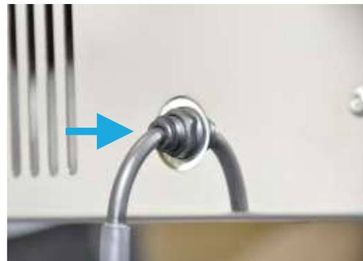
2. Controllare che il cavo dell'interruttore a pedale sia collegato alla macchina.
