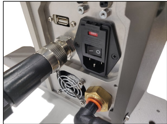
Abb. 7. Anschließen der Luftpumpe an der Rückseite der Maschine.
