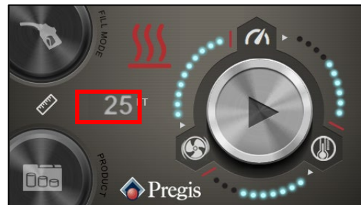
Abb. 20. Länge und Zeit können durch Auswahl des Symbols Laufzeit/Länge eingestellt werden.
