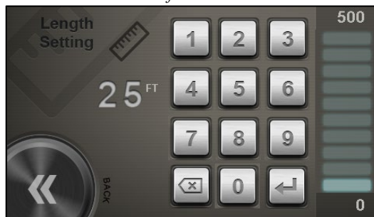
Abb. 21. Der Längenmodus ermöglicht es dem Benutzer, die eingestellte Kissenlänge auszuwählen, wenn die Start -Taste gedrückt wird.
