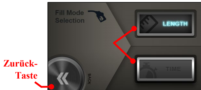
Abb. 19. Das Menü Füllmodusauswahl ermöglicht dem Benutzer, zwischen Länge und Zeit pro Durchlauf umzuschalten.
