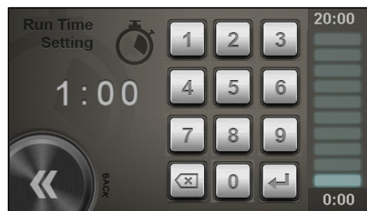
Abb. 22. Der Zeitmodus hat eine ähnliche Funktion, aber die Laufzeit wird in Minuten und Sekunden bestimmt.
