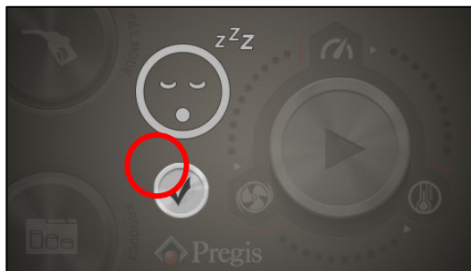
Abb. 16. Aktivieren Sie die Maschine, indem Sie die Taste zum Aktivieren aus dem Ruhemodus drücken.
